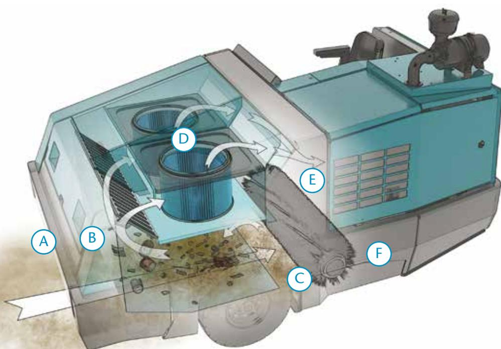
**A** Un capteur de température Thermo-Sentry™ surveille le bac à déchets et en cas de surchauffe dangereuse, désactive l'aspiration.
