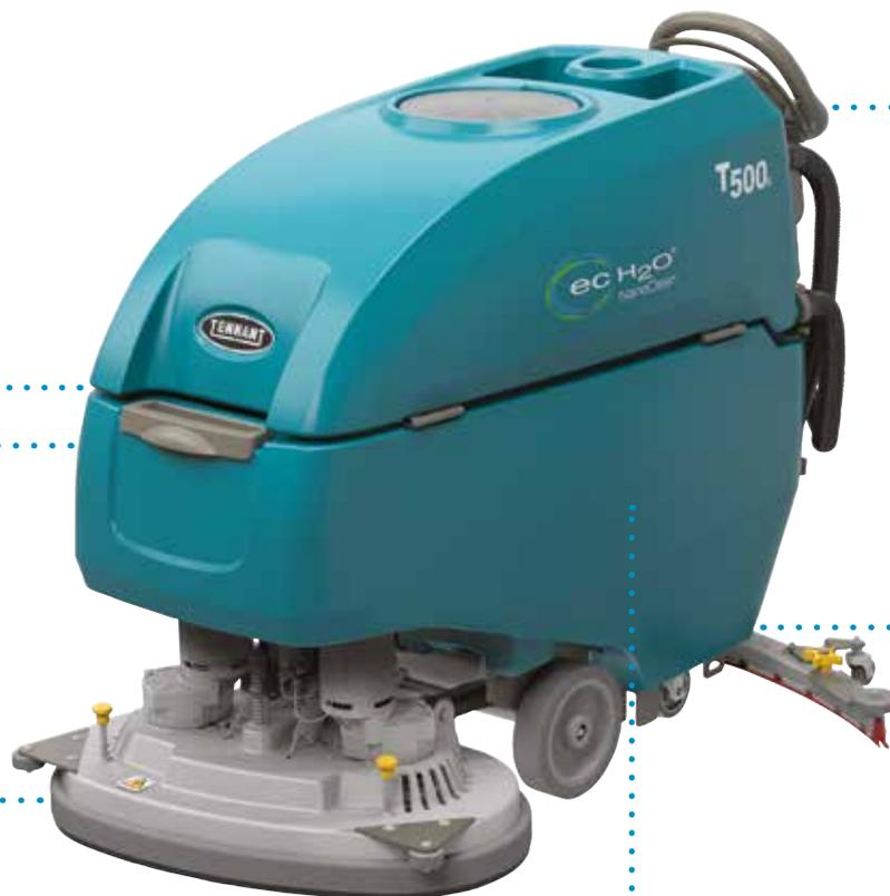
La technologie ec-H2O NanoClean® en option permet de minimiser la consommation d'eau
