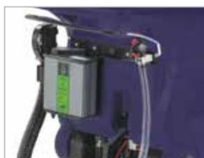
**Niveau du réservoir de solution** et tuyau de vidange
